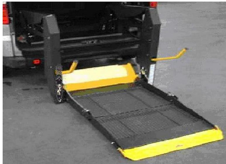
Главное преимущество складной конструкции лифта заключается в отсутствии особых технических требований к высоте крыши Вашего транспортного средства, даже в том случае, если Вам необходима удлиненная платформа для кресла-коляски с большой грузоподъемностью или кресла-коляски с электроприводом.
