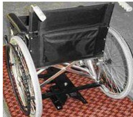
В случае если замок не закроется автоматически – последует звуковой сигнал. Только когда кресло-коляска будет зафиксирована звуковой сигнал остановится.
