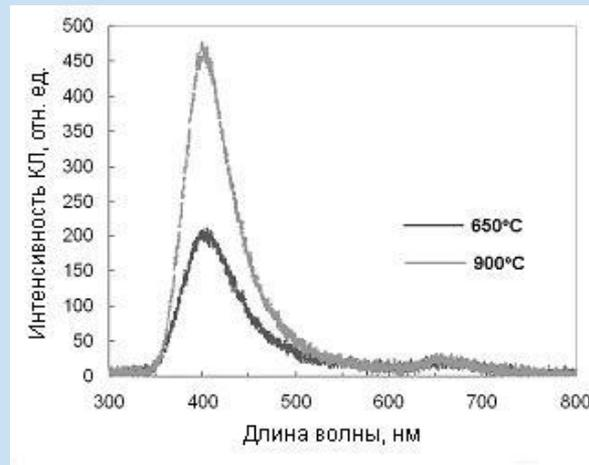
**Рис.4.** Спектры катодолуминесценции от образцов “А”, отожженных в атмосфере сухого азота в течение 30 мин при 650°С (черный) и 900°С (серый).
