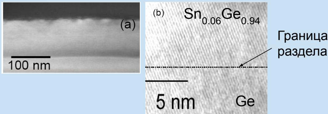
Рис. 4. ПЭМ микрофотографии структуры  $\text{Sn}_{0.06}\text{Ge}_{0.94}/\text{Ge}$  (23 нм).
