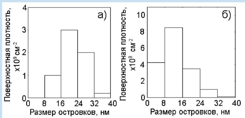
**Рис. 3.** Распределение островков по размерам для структур, выращенных методом МЛЭ при  $500^\circ\text{C}$ :
