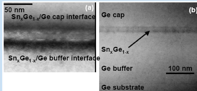
Рис. 2. ПЭМ микрофотографии структуры  $\text{Sn}_{0.03}\text{Ge}_{0.97}/\text{Ge}$  (23 нм).
