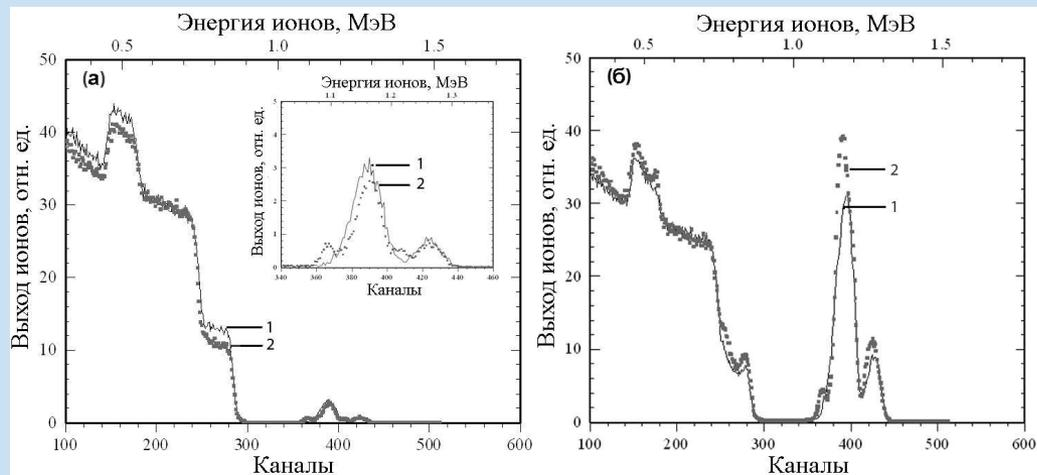
**Рис.1.** Спектр РОР от образцов “А” (а) и “В” (б) после отжига в атмосфере сухого азота в течение 30 мин при: 1 - 650°C и 2 - 900°C.
