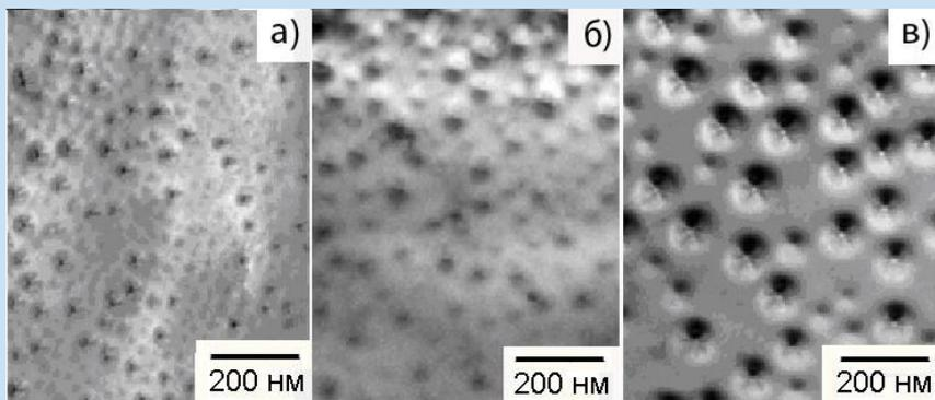
**Рис. 1.** ПЭМ микрофотографии образцов структуры ( $11\text{\AA}$  Ge + 2,5% Sn), выращенной при температурах МЛЭ:
