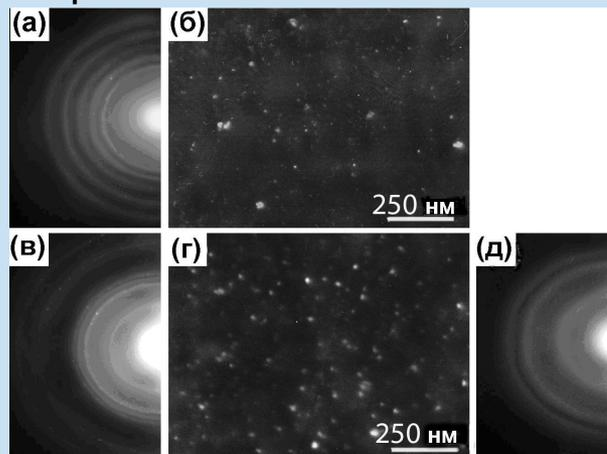
**Рис.2.** Изображения электронной дифракции (а, в, д) и темнопольные ПЭМ микрофотографии (б, г) образцов “А” отожженных при 408°C (а, б), 650°C (в, г) и 900°C (д) в течение 30 мин в атмосфере сухого азота.
