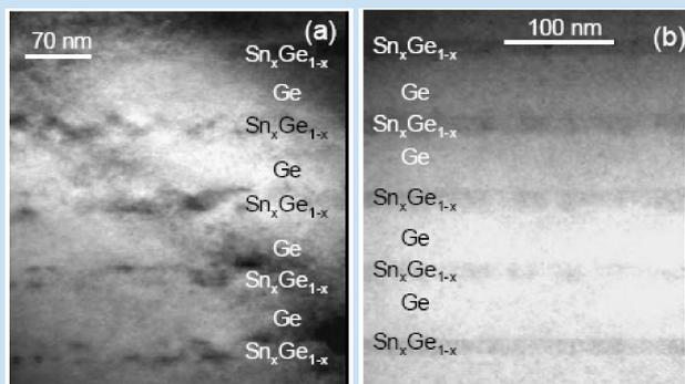
Рис. 1. ПЭМ микрофотографии структуры из 5 слоев  $\text{Sn}_{0.02}\text{Ge}_{0.98}/\text{Ge}$
