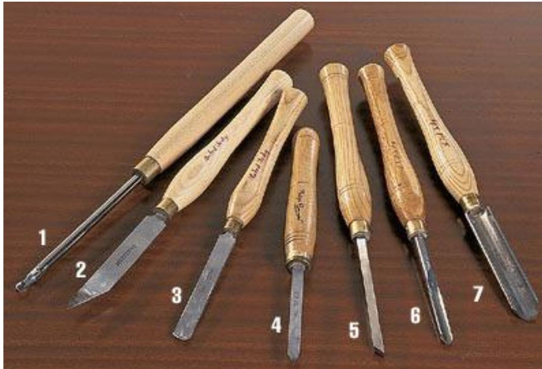
**6. Полукруглая стамеска для обработки фасонной поверхности**
