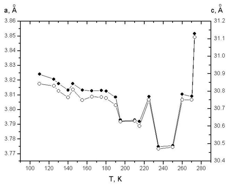
Температурная зависимость параметров элементарной ячейки, по данным нейтронографии (вверху) и рентгенографии (внизу). Черные символы – параметр  $a$ , белые – параметр  $c$ .
