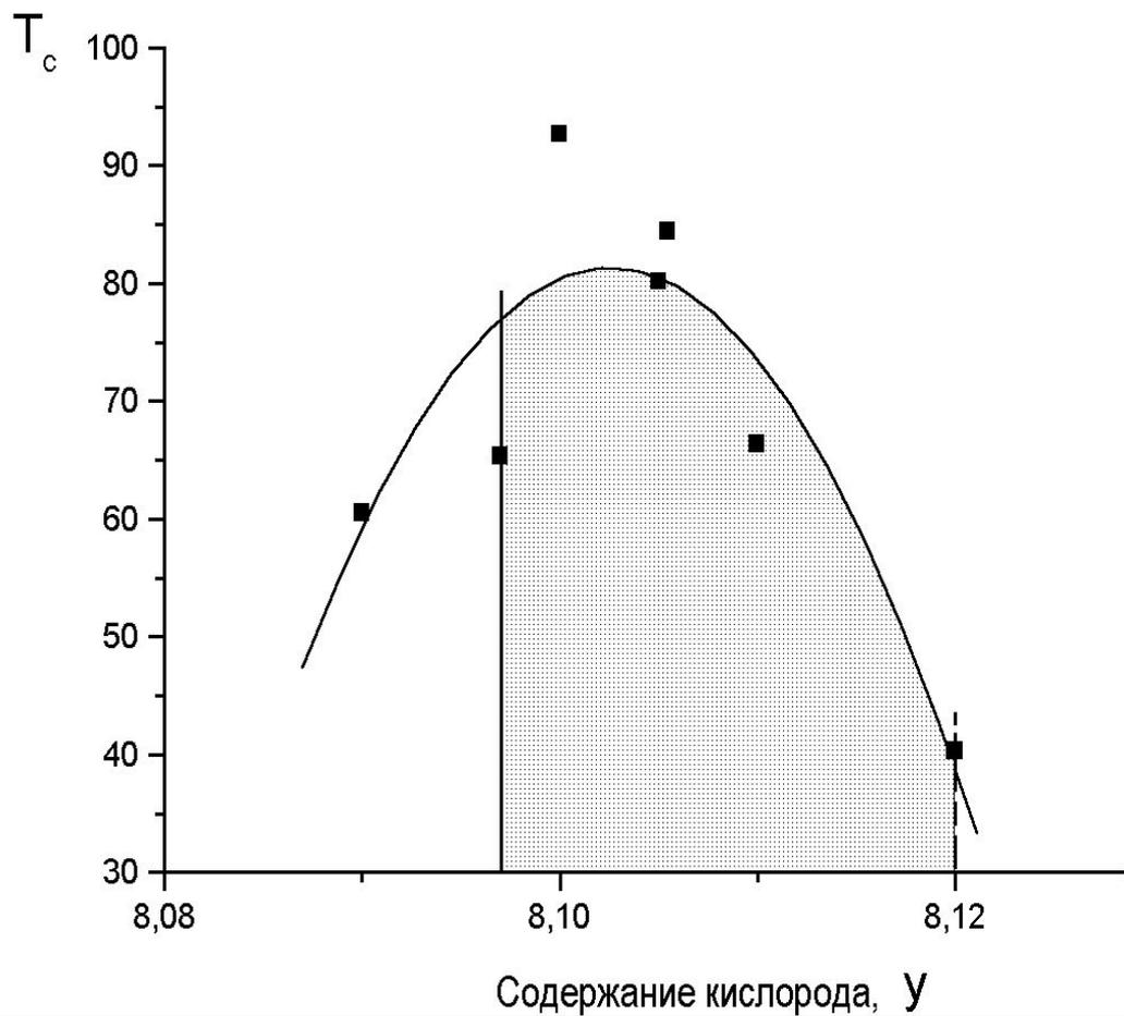
*Зависимость температуры перехода в сверхпроводящее состояние от содержания кислорода*
