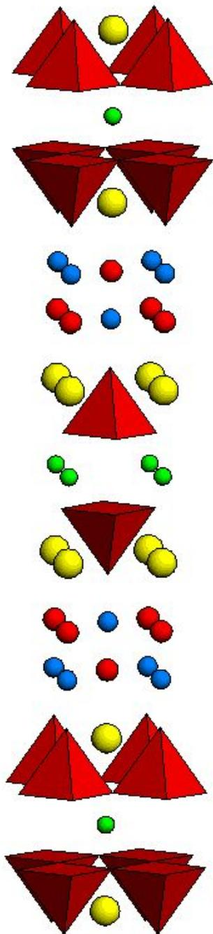
*Схематическое изображение кристаллической структуры  $\text{Bi}_2\text{Sr}_2\text{CaCu}_2\text{O}_y$ . Красным показаны атомы кислорода, желтым – стронция, голубым – висмута, зеленым – кальция. Атомы меди располагаются в середине плоскости основания  $\text{CuO}_5$ -пирамид. Блок  $\text{BiO}$  имеет структуру типа  $\text{NaCl}$ , а блок  $\text{CuO}_5\text{-Ca-CuO}_5$  – структуру типа «перовскит».*
