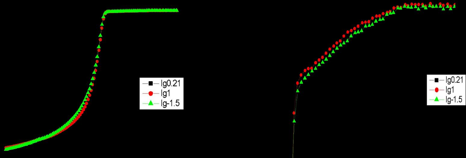
Рис.1. Температурная зависимость действительной компоненты АС-восприимчивости для  $(\text{Bi Pb})_2\text{Sr}_2\text{CaCu}_2\text{O}_y$  ( $f = 79 \text{ Hz}$ ,  $H_{\sim} = 9 \text{ Oe}$ ), отожженного при  $\lg P(\text{o}_2) = 0.21; 1; -1.5$ .  $T_c \approx 104^\circ\text{K}$
