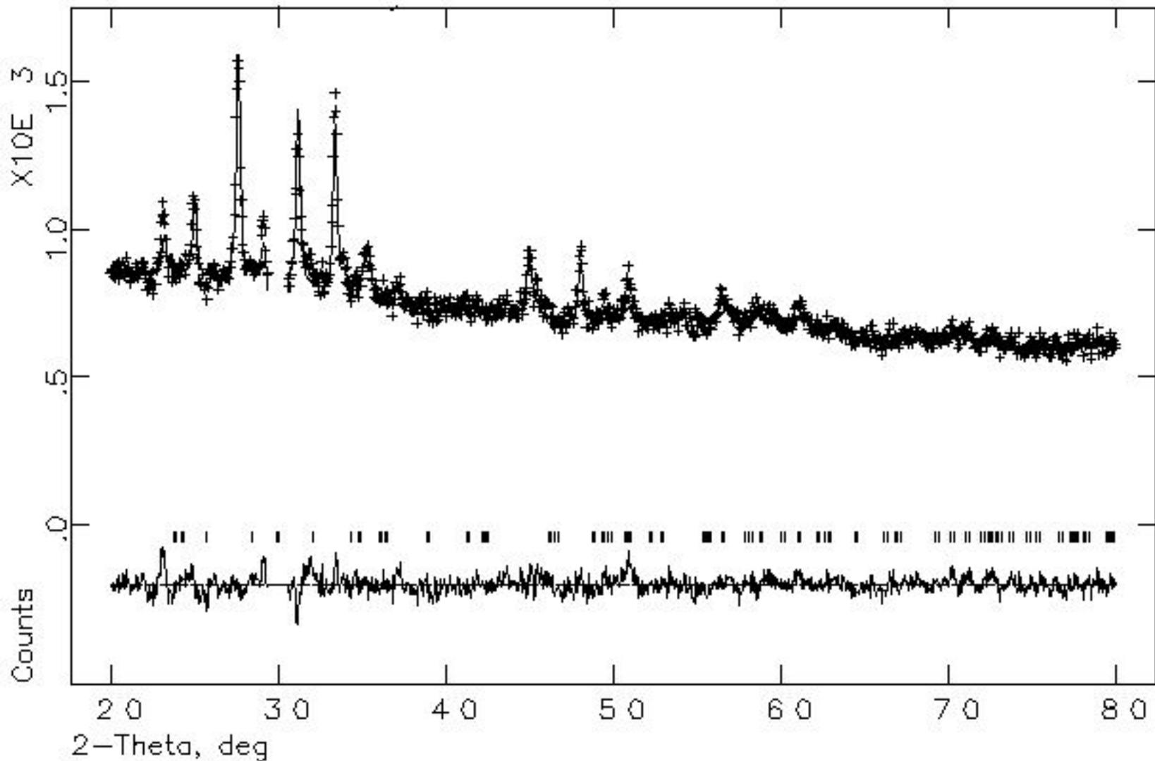
*Экспериментальная, расчетная и разностная рентгенограмма
