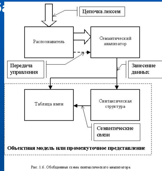
Рис. 1.6. Обобщенная схема синтаксического анализатора
