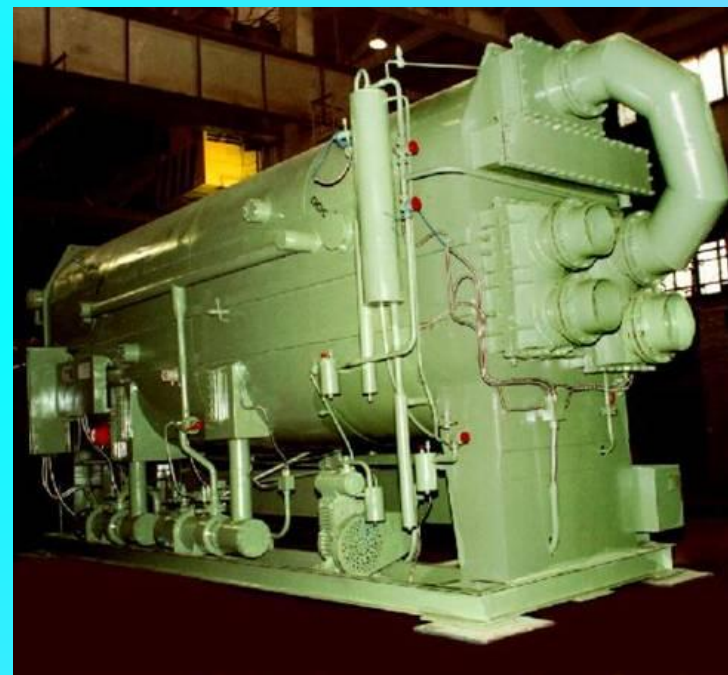
Абсорбционная холодильная машина АБХМ-2000 (2 МВт) (ИТ СО РАН, «Теплосибмаш»)
