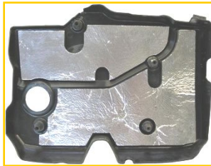
Шумопоглощающие панели верхнего экрана двигателя (AA15SMT) BA3-2110, 21214, 1118 «Калина», 2170 «Приора»
