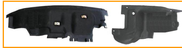
Надставка щитка передка с пористым звукопоглощающим и плотным звукоотражающим слоем BA3-2110, 2170 «Приора»
