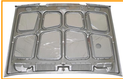
Шумопоглощающие панели верхнего экрана двигателя (AA15SMT) BA3-2110, 21214, 1118 «Калина», 2170 «Приора»
