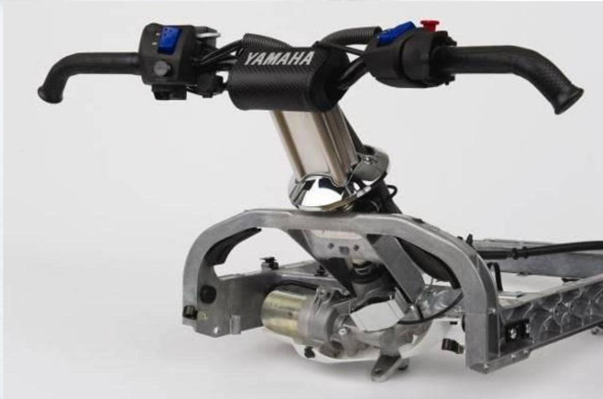
Первый электроусилитель на снегоходе. Снижает прилагаемое усилие, уменьшает отдачу на руль, улучшает управляемость. Вы можете управлять дольше, активнее, путешествовать на большие расстояния.
