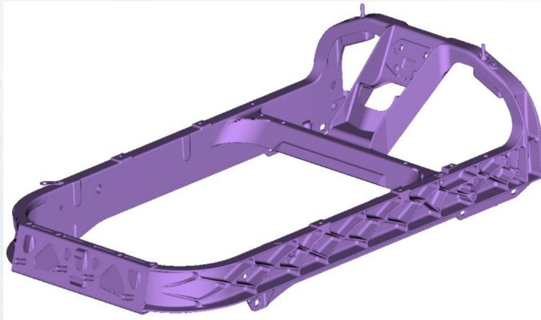
У вновь разработанной несущей рулевой опоры увеличена жесткость и снижен вес.
