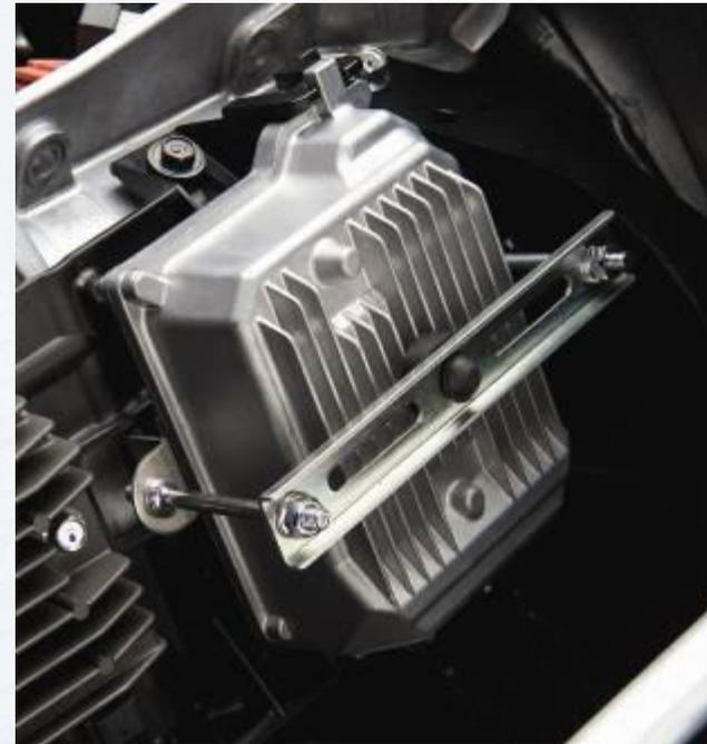
Механический руль с электрическим усилителем, срабатывающий в нужный момент. Системные датчики снимают механические усилия с рулевой колонки, сигналы с EPS модуля передаются на электрический силовой привод для передачи необходимого усилия рулевому управлению.
