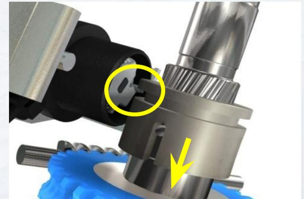
Больше усилия= больше движение муфты= больше движение концевика
