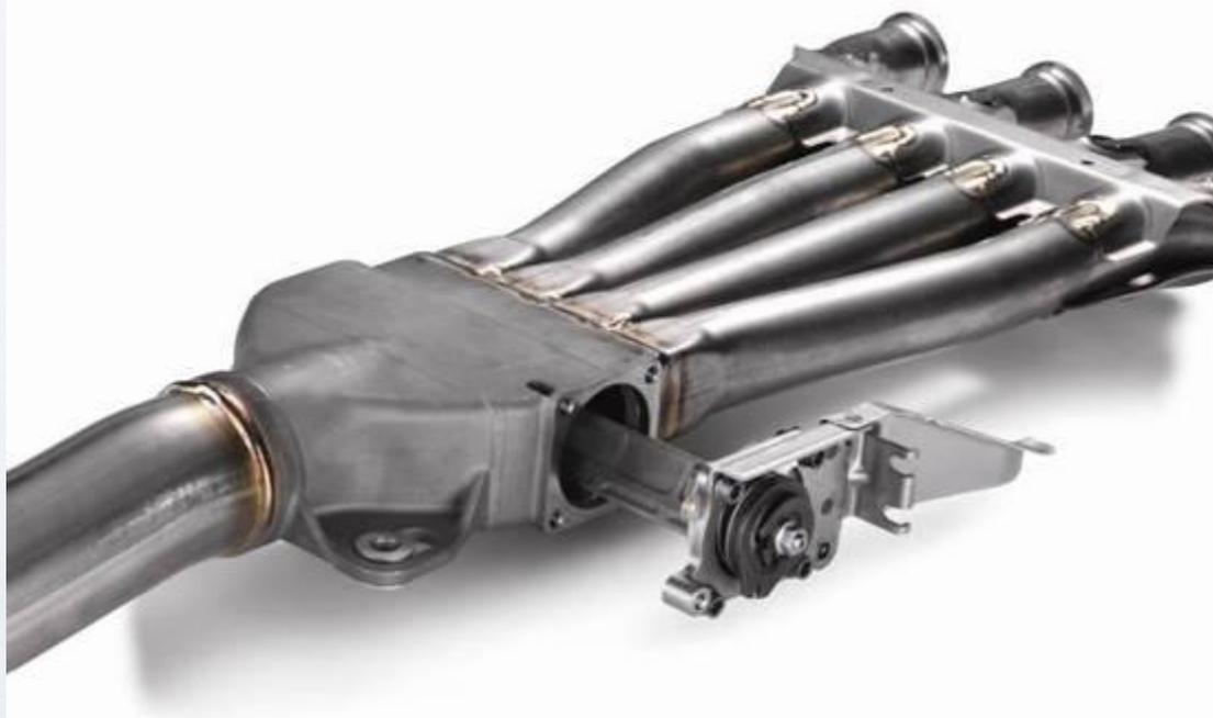
Клапан системы EXUP расположен в точке соединения выпускных коллекторов. Его работа регулирует показатель обратного давления в выпускной системе. Клапан EXUP приводится в действие сервомотором, управляемым ECU. Лучше всего работа системы EXUP сочетается с 5-и клапанными двигателями.
