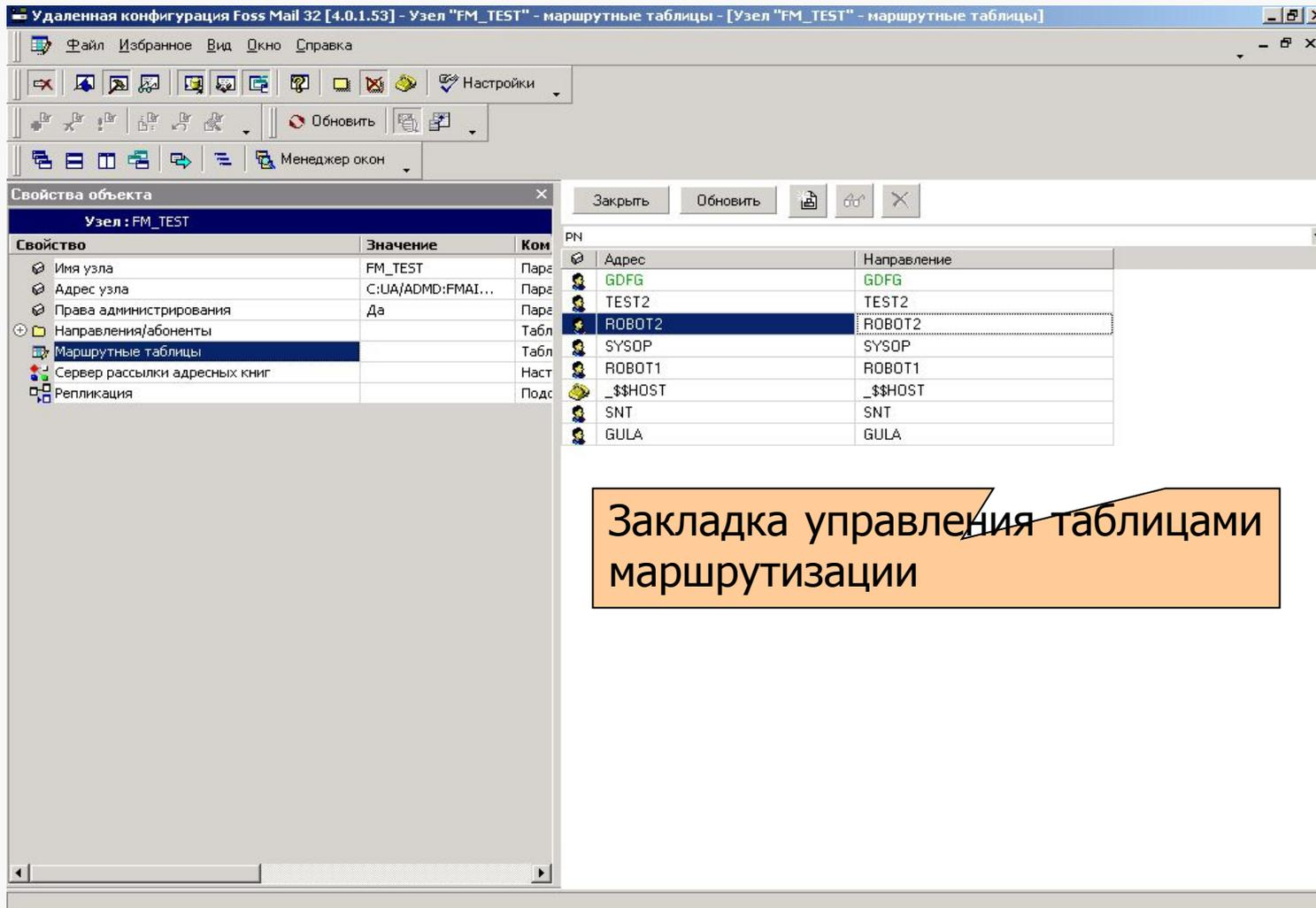
The screenshot displays the 'Удаленная конфигурация Foss Mail 32 [4.0.1.53] - Узел "FM\_TEST" - маршрутные таблицы' window. The 'Свойства объекта' pane on the left shows the configuration for the 'Узел : FM\_TEST' node, with 'Маршрутные таблицы' selected. The main area shows a table of routing rules:
