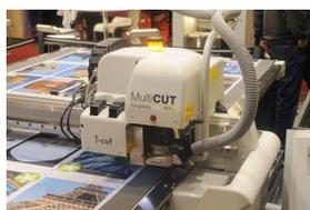
**ESKO Kongsberg XL44** — промышленный режущий плоттер для фигурной порезки и фрезеровки с рабочей зоной 2,1х3,1м. Позволяет резать практически любые материалы используемые для изготовления рекламы, выставочной продукции и торгового оборудования: пластики ПВХ, композиты, акрилы и т.п.
