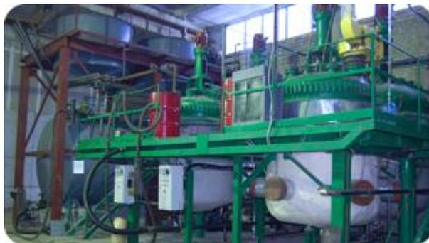
Производственное оборудование и резервуары для хранения сырья и готовой продукции связаны в единую систему, которая не допускает смешения различных видов масел в процессе производства и хранения. Производство сертифицировано в системе «Укрсеπρο».
