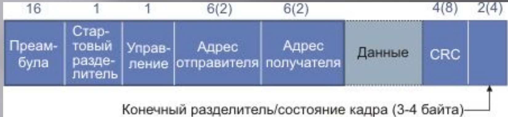
Рис. 4. Формат пакета протокола FDDI
