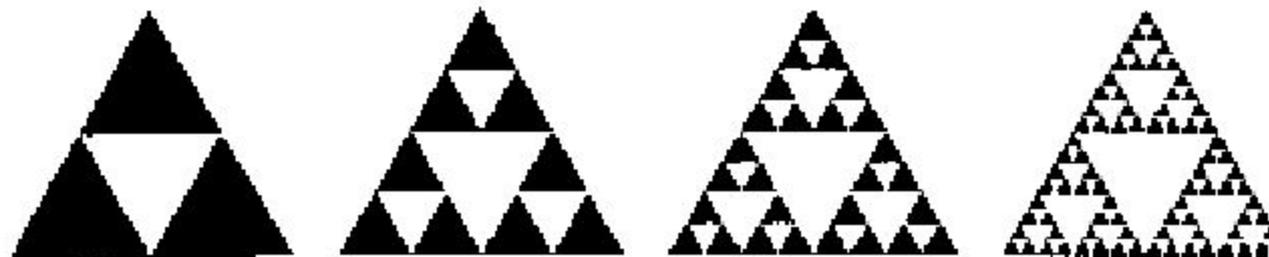
РИС. 2.15. Построение треугольной салфетки Серпинского. Затравка – треугольник со всеми внутренними точками. Образующий элемент исключает из затравки центральную треугольную. *Справа:* четвертое поколение предфракталов; фрактальная кривая получается в пределе при бесконечно большом числе поколений и имеет фрактальную размерность  $D = \lg 3 / \lg 2 = 1,58 \dots$ .
