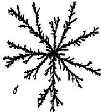
РИС. 4.5. Радиальное образование вязких пальцев в круглой ячейке Хале-Шоу: а-воздух вытесняет глицерин при  $Ca = 0,1$  [123]; б-вода вытесняет неэвотонную смесь склероглицина с водой, обладающую высокой вязкостью. Эта структура фрактальна с  $D = 1,70 \pm 0,05$  [44].
