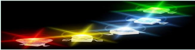
Работа **светодиодов** основана на испускании фотонов, которое возникает при контакте полупроводниковых материалов и сопровождается свечением
