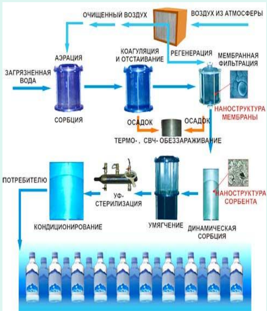
Схема установки для обработки поверхностных вод и последующей доочистки воды с помощью нанофильтрации
