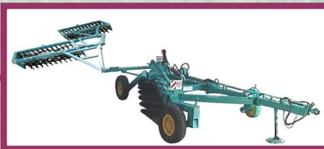
ПП-9-35; ПНУ-8-40П; ПН-4-35П – плуги общего назначения в агрегате с кольчато-кольцевыми катками КИК
