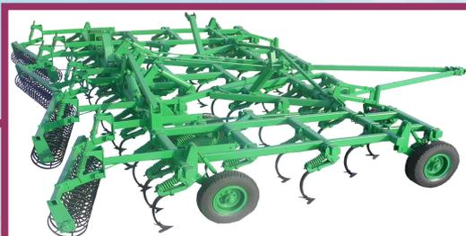
КРГ – Культиватор разноглубинной обработки
