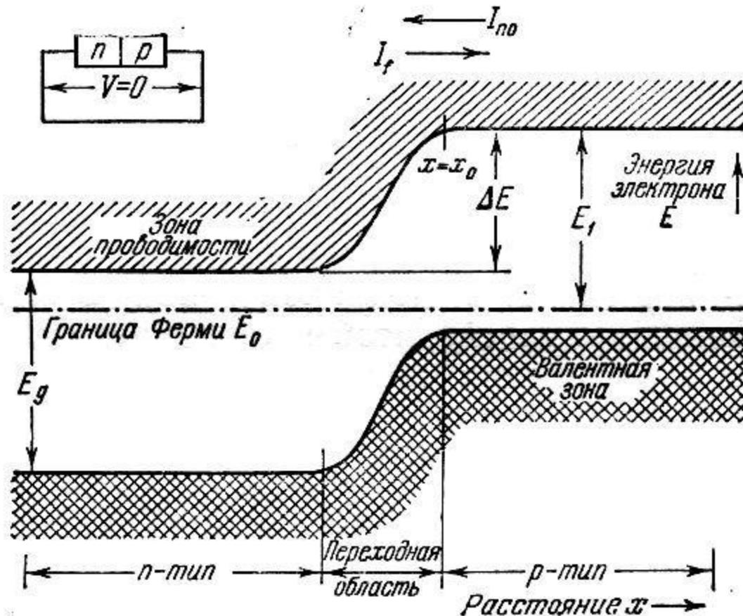
Рис. 11.8. Энергетическая диаграмма  $p-n$ -перехода, находящегося в равновесии. Границы Ферми по обеим сторонам контакта сравниваются, так что дырочные и электронные токи в обоих направлениях оказываются одинаковыми.
