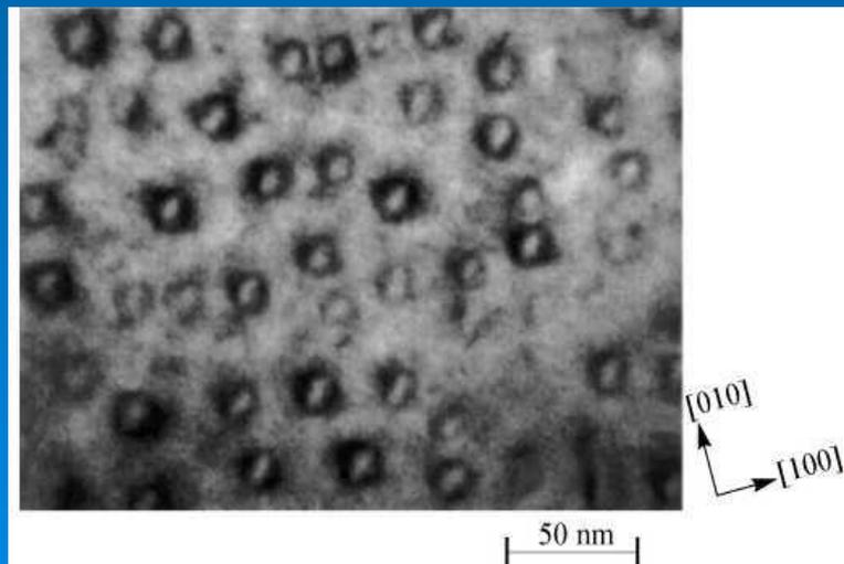
Изображение квантовых точек InAs в матрице GaAs (вид сверху), полученное с помощью просвечивающей электронной микроскопии
