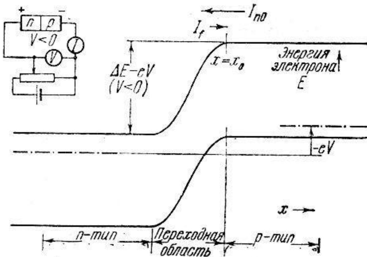
Рис. 11.9. Энергетическая диаграмма  $p-n$ -перехода с приложенным отрицательным смещением. Напряжение  $V < 0$ , ток мал и почти не зависит от  $V$ . Показан только график электронного тока, но дырочный ток также мал и почти не зависит от  $V$ .
