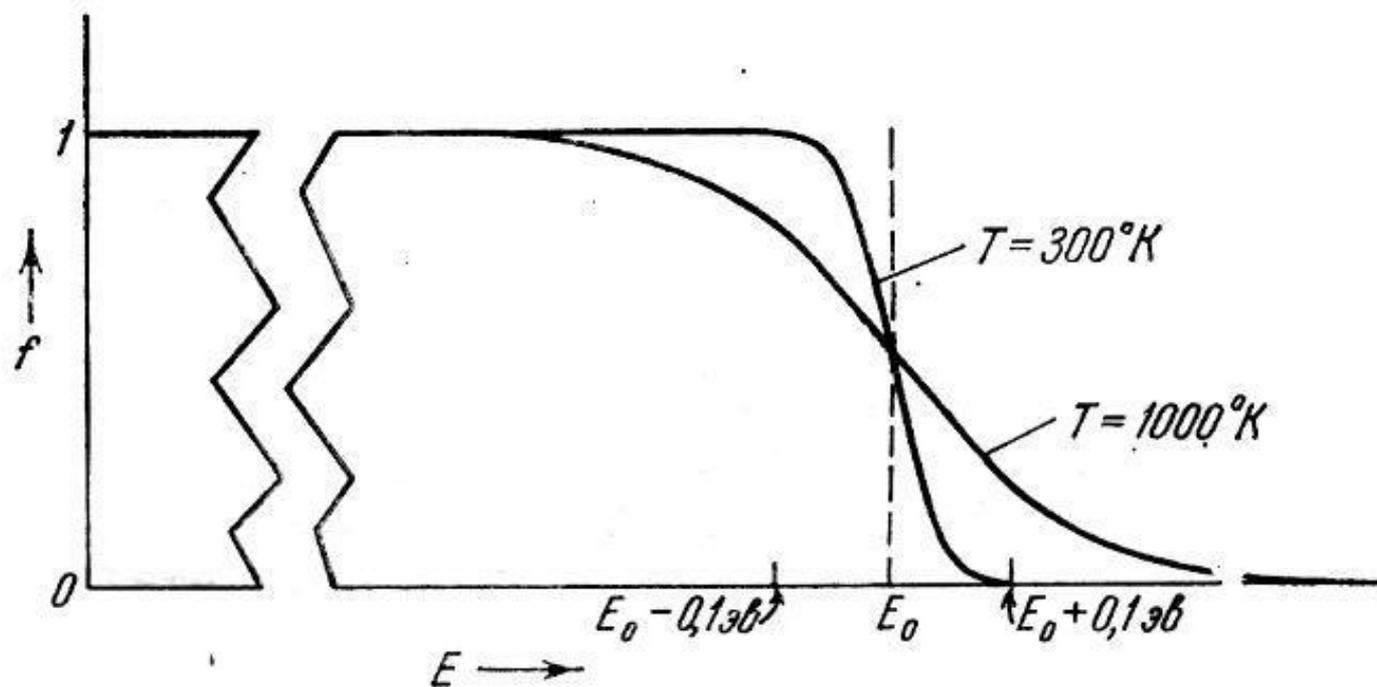
Рис. 9.6. Распределение Ферми  $f$  в функции энергии при двух температурах. Отметим, что изменение  $f$  имеет место только в пределах области шириной порядка нескольких  $kT$  вблизи границы Ферми  $E_0$ . Нулевое значение  $E$  может быть на несколько электронвольт или на много электронвольт ниже  $E_0$ , поскольку выбор значения  $E=0$  произволен.
