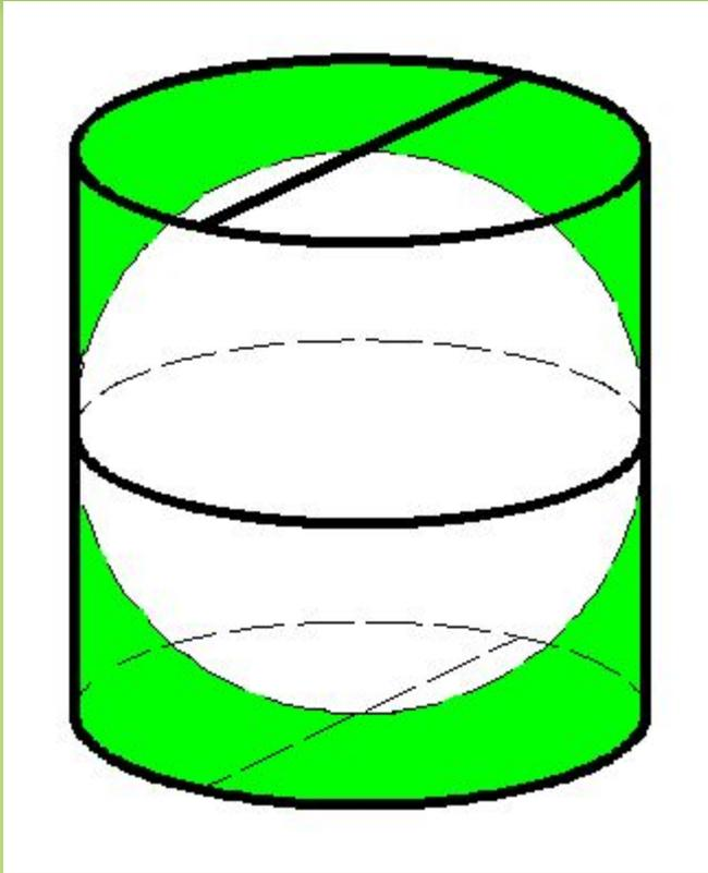
В сосуд цилиндрической формы, наполненный водой доверху, положили металлический шар, который касается дна и стенок. Определите отношение объема воды, которая осталась в сосуде, к объему воды, которая вылилась.
