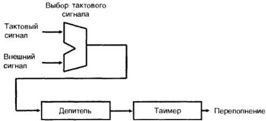
Структура таймера в микроконтроллере
