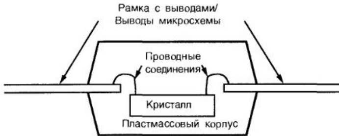
Пластмассовый корпус для однократно программируемых приборов
