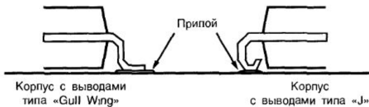
Планарная технология корпусов
