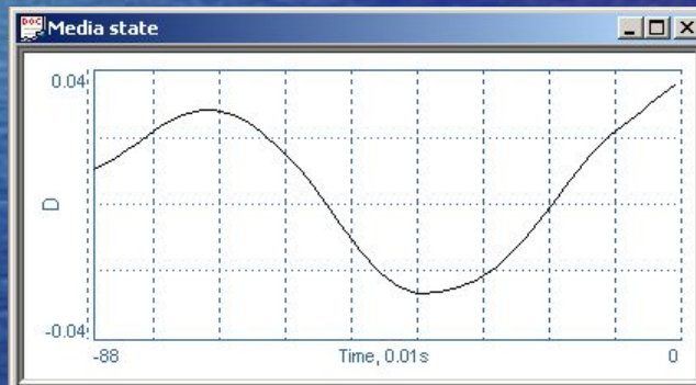
Колебания автомобиля без системы AdCAS
