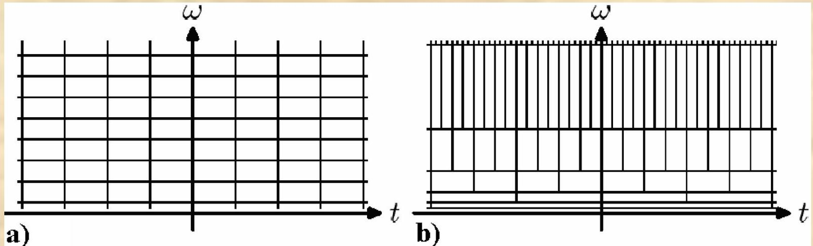
В случае частотно-временного представления покрытие состоит из одинаковых прямоугольников, транслируемых по всей плоскости. В случае масштабнo-временного представления прямоугольники имеют одинаковую площадь, но их относительная разрешающая способность по частоте остается при этом неизменной
