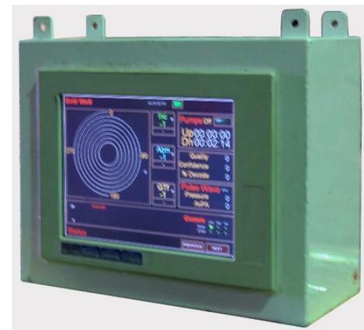
Новый беспроводной терминал имеет водонепроницаемую конструкцию и встроенный подогрев, что позволяет пользоваться им на открытом воздухе в любую погоду.
