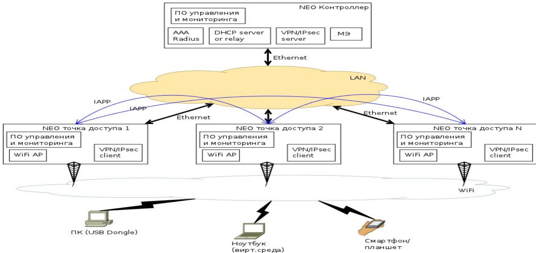
Программно-аппаратный комплекс «Туннель-WiFi» предназначен для построения защищенных сегментов беспроводных сетей **WiFi 802.11b/g/n** с использованием **алгоритмов шифрования ГОСТ**.
