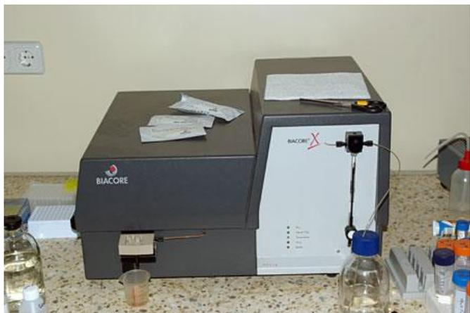
Прибор для исследований методом поверхностно-плазмонного резонанса **Biacore X**
