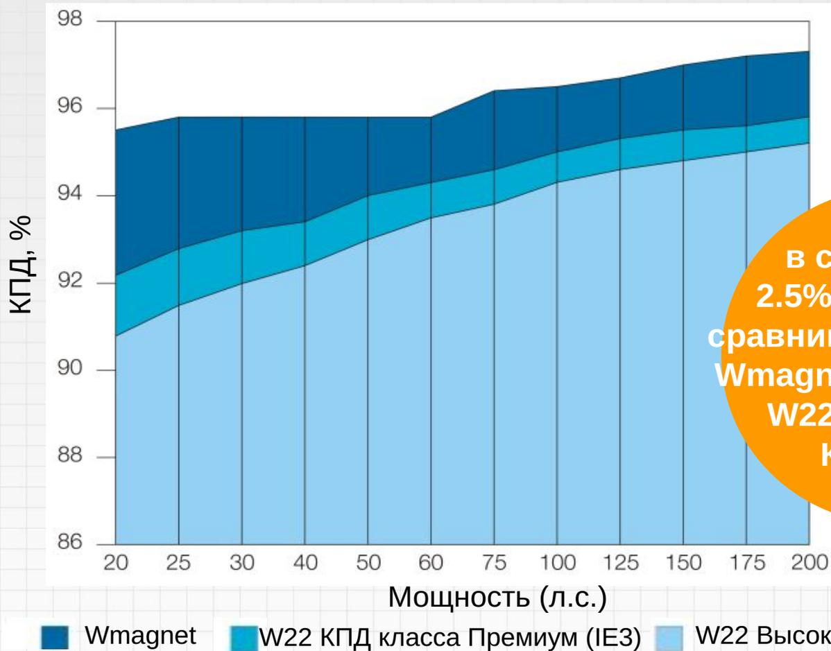
КПД, в среднем, на 2.5% выше, если сравнивать двигатель Wmagnet и двигатель W22 с высоким КПД (IE2)
