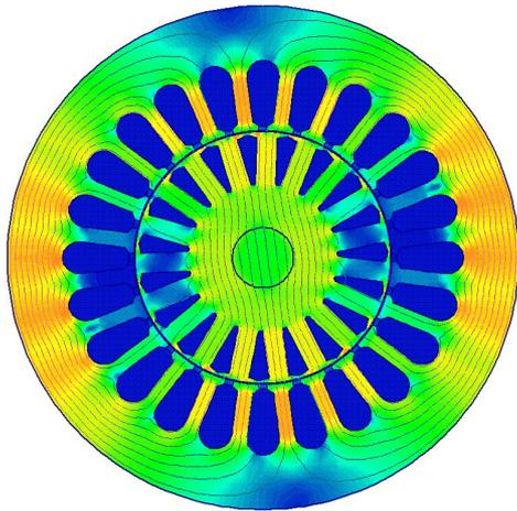
Линии передачи тока статора проходят через ротор, индуцируя ток и создавая магнитное поле. Вследствие этого происходят потери и выделяется тепло.
