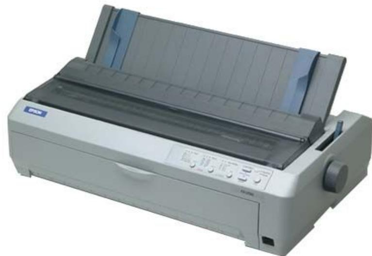
*Матричные принтеры* — это принтеры ударного действия. Печатающая головка матричного принтера состоит из вертикального столбца маленьких стержней (обычно 9 или 24), которые под воздействием магнитного поля «выталкиваются» из головки и ударяют по бумаге (через красящую ленту). Перемещаясь, печатающая головка оставляет на бумаге строку символов.
