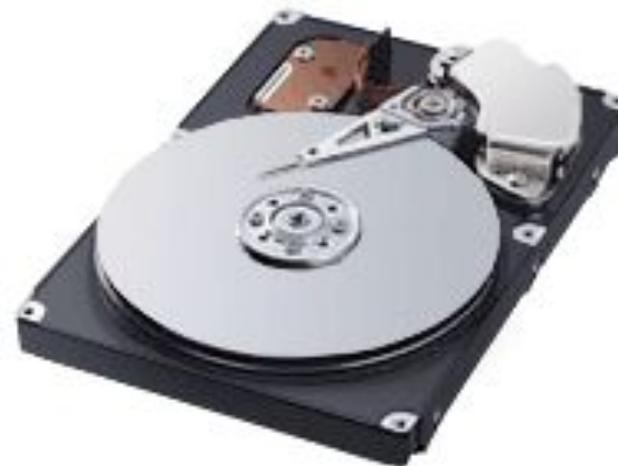
НЖМД встроены в дисковод и являются несъемными. Они представляют собой несколько алюминиевых дисков с магнитным покрытием, заключенных в единый корпус с электродвигателем, магнитными головками и устройством позиционирования. К магнитной поверхности диска подводится записывающая головка, которая перемещается по радиусу диска с внешней стороны к центру. Во время работы дисковода диск вращается.
