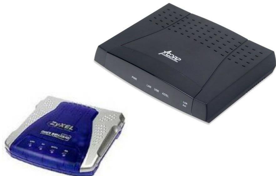
**Модем** или модемная плата служит для связи удалённых компьютеров по телефонной сети. Модем бывает внутренний (установлен внутри системного блока) и внешний (располагается рядом с системным блоком и соединяется с ним при помощи кабеля).
