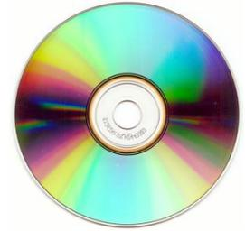
**CD** – Compact Disk. Изготавливают из органических материалов с напылением на поверхность тонкого алюминиевого слоя. Лазерный диск имеет одну дорожку в виде спирали.
