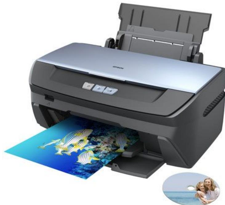
В последние годы широкое распространение получили *струйные* принтеры. В них используется чернильная печатающая головка, которая под давлением выбрасывает чернила из ряда мельчайших отверстий на бумагу. Перемещаясь вдоль бумаги, печатающая головка оставляет строку символов или полосу изображения.
