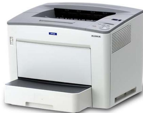
*Лазерные* принтеры обеспечивают практически бесшумную печать. Высокую скорость печати (до 30 страниц в минуту) лазерные принтеры достигают за счет постраничной печати, при которой страница печатается сразу целиком. Высокое типографское качество печати лазерных принтеров обеспечивается за счет высокой разрешающей способности, которая может достигать 1200 dpi и более.
