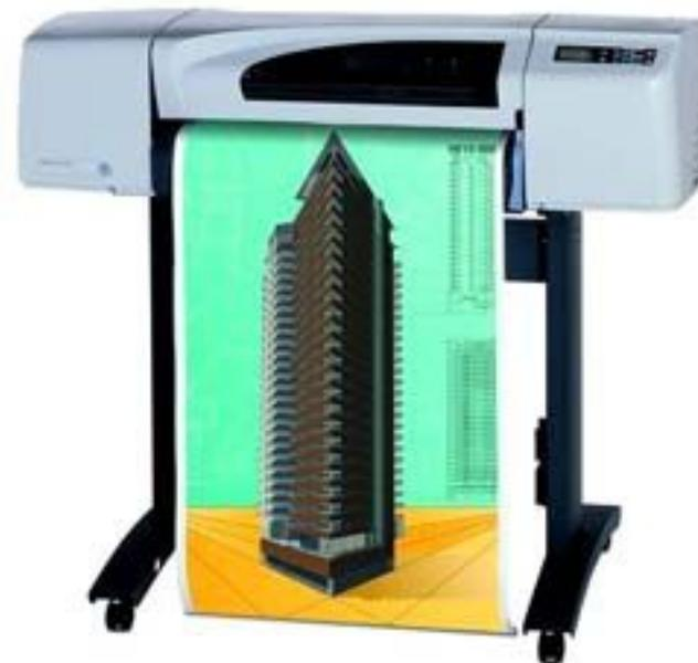
**Плоттер (графопостроитель).** Для вывода сложных и широкоформатных графических объектов (плакатов, чертежей, электрических и электронных схем и пр.) используются специальные устройства вывода — плоттеры. Принцип действия плоттера такой же, как и струйного принтера.
