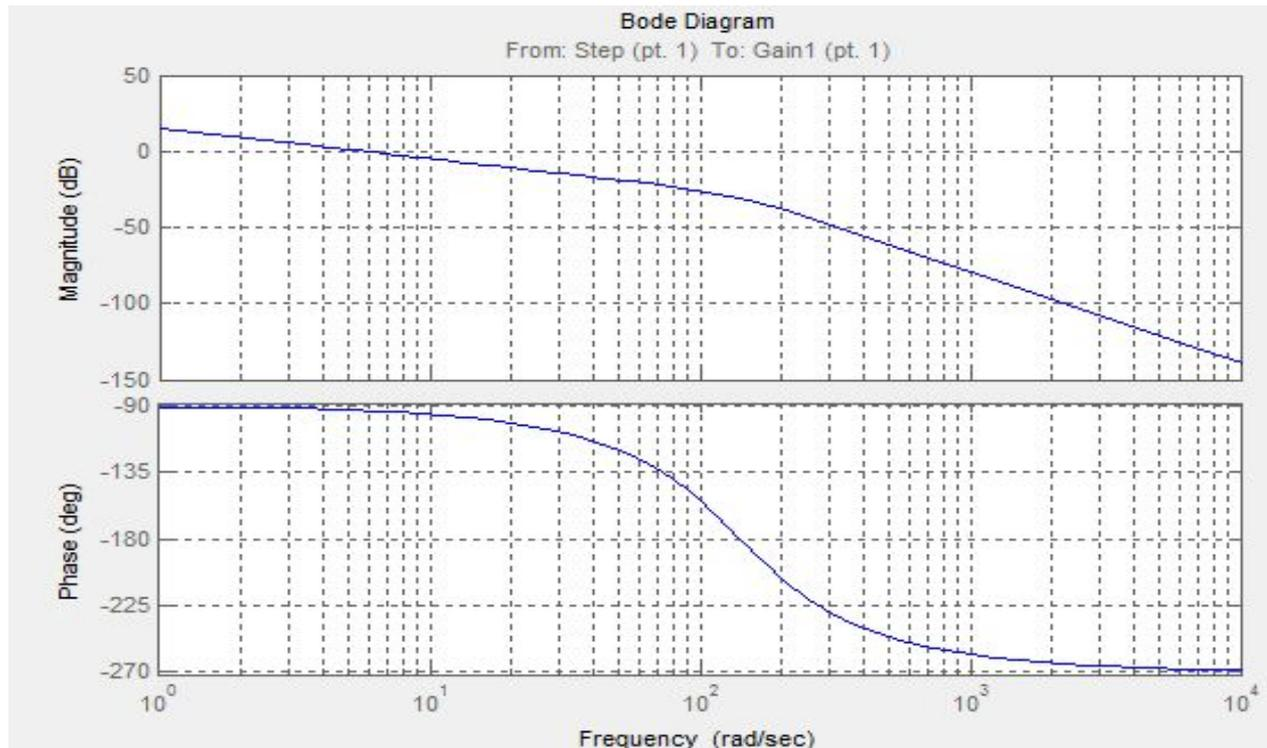
Передаточная функция разомкнутой ССПУ
