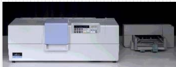
Поляриметр Perkin Elmer Polarimeter 341
