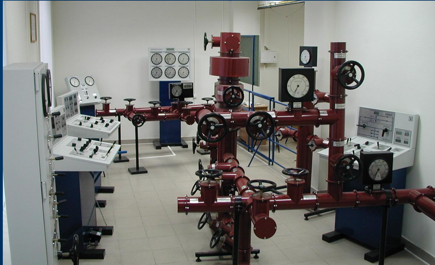
Многофункциональный тренажер-имитатор бурения скважин
