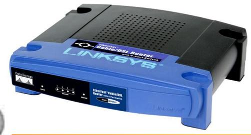
**Точка доступа** – устройство для организации беспроводной локальной сети (используют радиоволны определённой частоты)
