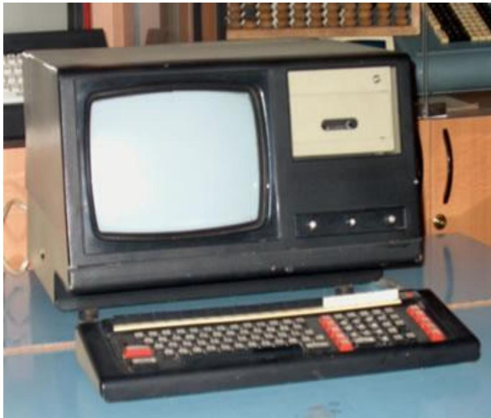
МикроЭВМ "Искра 1256" предназначена для сбора и обработки информации в системах автоматизации научных исследований с небольшим количеством датчиков и для решения различных инженерно-технических и экономических задач.
