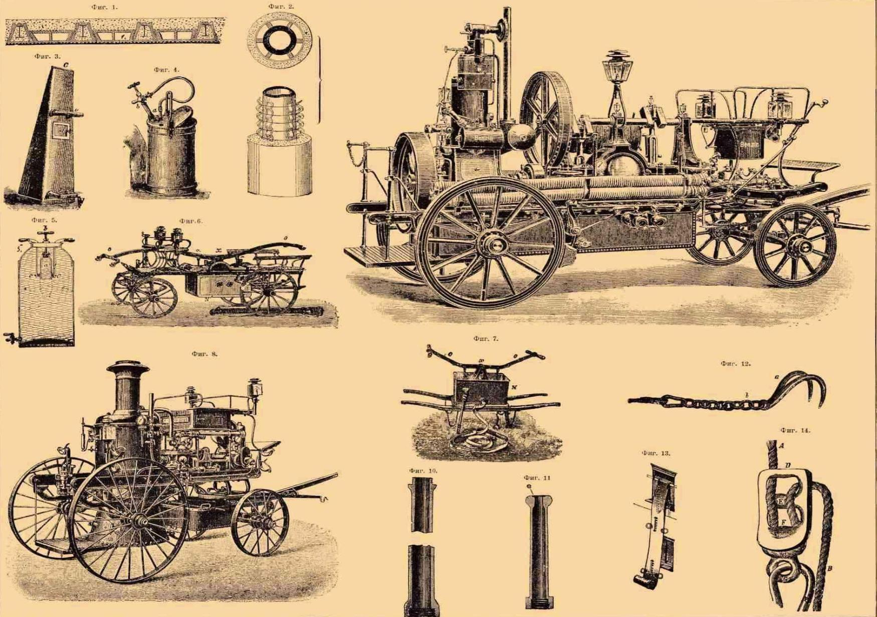
Фиг. 1—огнеупорное перекрытие. Фиг. 2—огнеупорная колонна. Фиг. 3—огнетушитель Шварца. Фиг. 4—ручной пожарный насос. Фиг. 5—экстинктор Бабкока. Фиг. 6 и 7—ручные пожарные насосы. Фиг. 8—паровая пожарная машина. Фиг. 9—бензиновая пожарная труба. Фиг. 10—стволь брандспойта. Фиг. 11—наконечник брандспойта. Фиг. 12—ломовая веревка. Фиг. 13—спасательный крючок. Фиг. 14—горлачный крючок.
