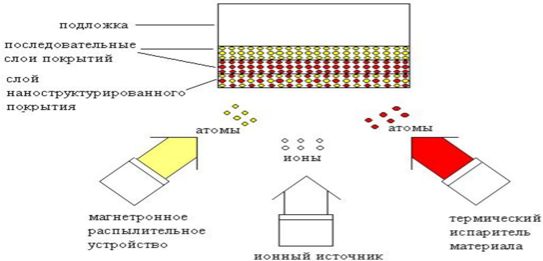
Рис. 3. Принципы наноструктурирования пленок и покрытий при их нанесении на подложку с использованием вакуумно-плазменных и ионных процессов
