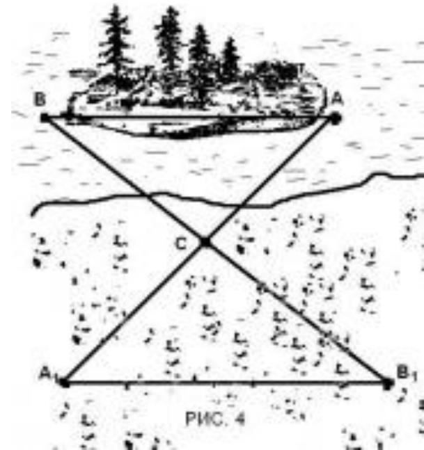
На берегу выберем точку  $C$ , из которой видны точки  $A$  и  $B$  (рис. 4), провесим прямые  $AC$  и  $BC$ . Отложим  $CA_1 = CA$ ,  $CB_1 = CB$ . Расстояние  $A_1B_1$  будет равно искомому расстоянию  $AB$ , т. к. треугольник  $ABC$  равен треугольнику  $A_1B_1C$  по двум сторонам и углу между ними ( $CA_1 = CA$ ,  $CB_1 = CB$ , угол  $BCA$  равен углу  $A_1CB_1$ , как вертикальные)
