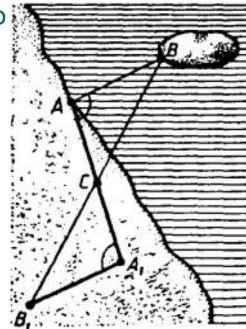
Провесив прямую  $AC$ , отложим  $AC = CA_1$ .  $\angle CAB$  измерим астролябией (или теодолитом) и через точку  $A_1$  провесим прямую  $A_1B_1$  так, чтобы  $\angle CA_1B_1 = \angle CAB$ . Тогда треугольник  $ABC$  равен треугольнику  $A_1B_1C$  (по стороне и двум прилежащим углам). Искомая длина кабеля  $A_1B_1$ .
