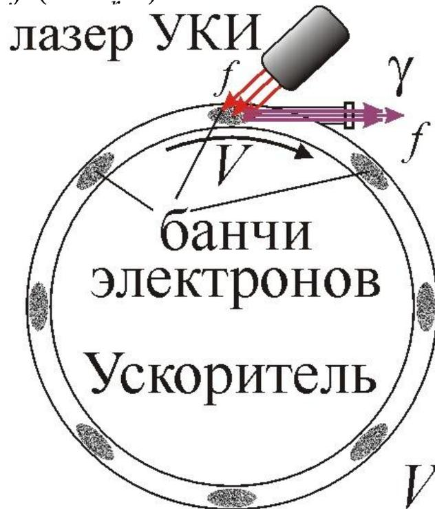
Преобразование лазерных ультракоротких импульсов в  $\gamma$ -лучи при отражении “электронным зеркалом”.
