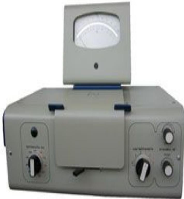
*Предназначен для измерения в отдельных участках диапазона длин волн 315-980 нм, выделяемых светофильтрами, коэффициентов пропускания и оптической плотности жидкостных растворов и твердых тел, а также определения концентрации веществ в растворах методом построения градуировочных графиков*
