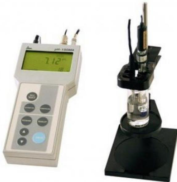
*Прибор для измерения водородного показателя (показателя рН), характеризующего концентрацию ионов водорода в растворах, питьевой воде, пищевой продукции и сырье, объектах окружающей среды и производственных системах непрерывного контроля технологических процессов, в том числе в агрессивных средах*
