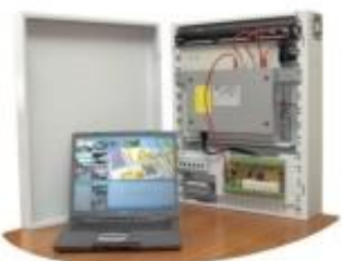
В «антивандальных» шкафах установлены 74 видеосервера «LABI-Pandora»
