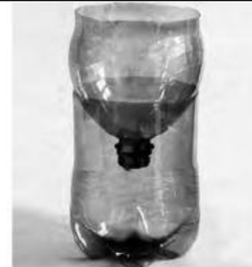
Рис. 30. Фильтровальная «установка» из пластиковой бутылки. В горлышко перевернутой части разрезанной бутылки вставлена вата
