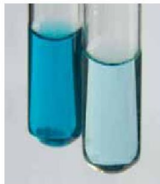
Рис. Ц-5. Концентрированный (слева) и разбавленный (справа) раствор \text{CuSO}_4
