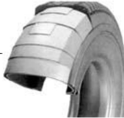
Каркас для автопокрышки из кордной ткани
