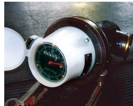
**Счетчики жидкости турбинные**
