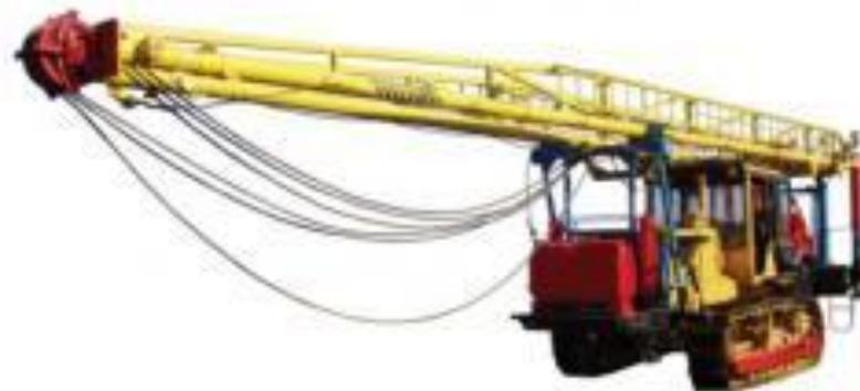
Агрегат для свабирования скважин А2-32-01
