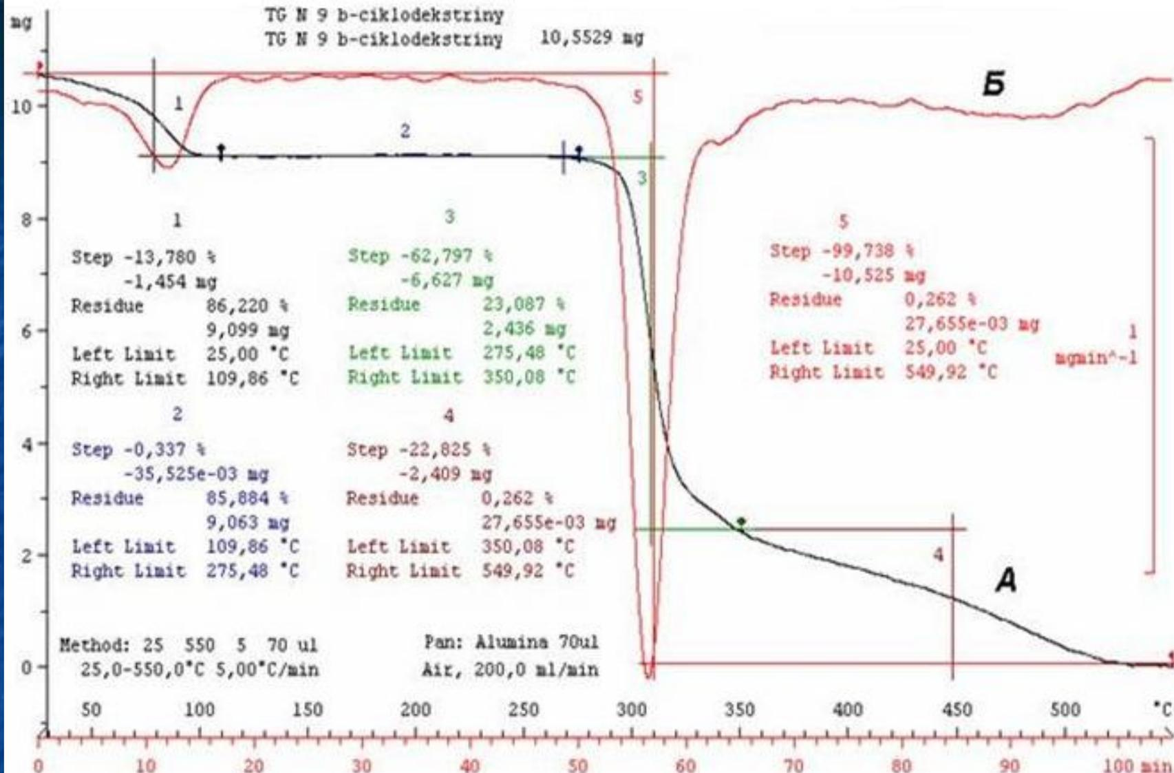
Рис. 4. Термогравиметрический анализ β-циклодекстрина .
