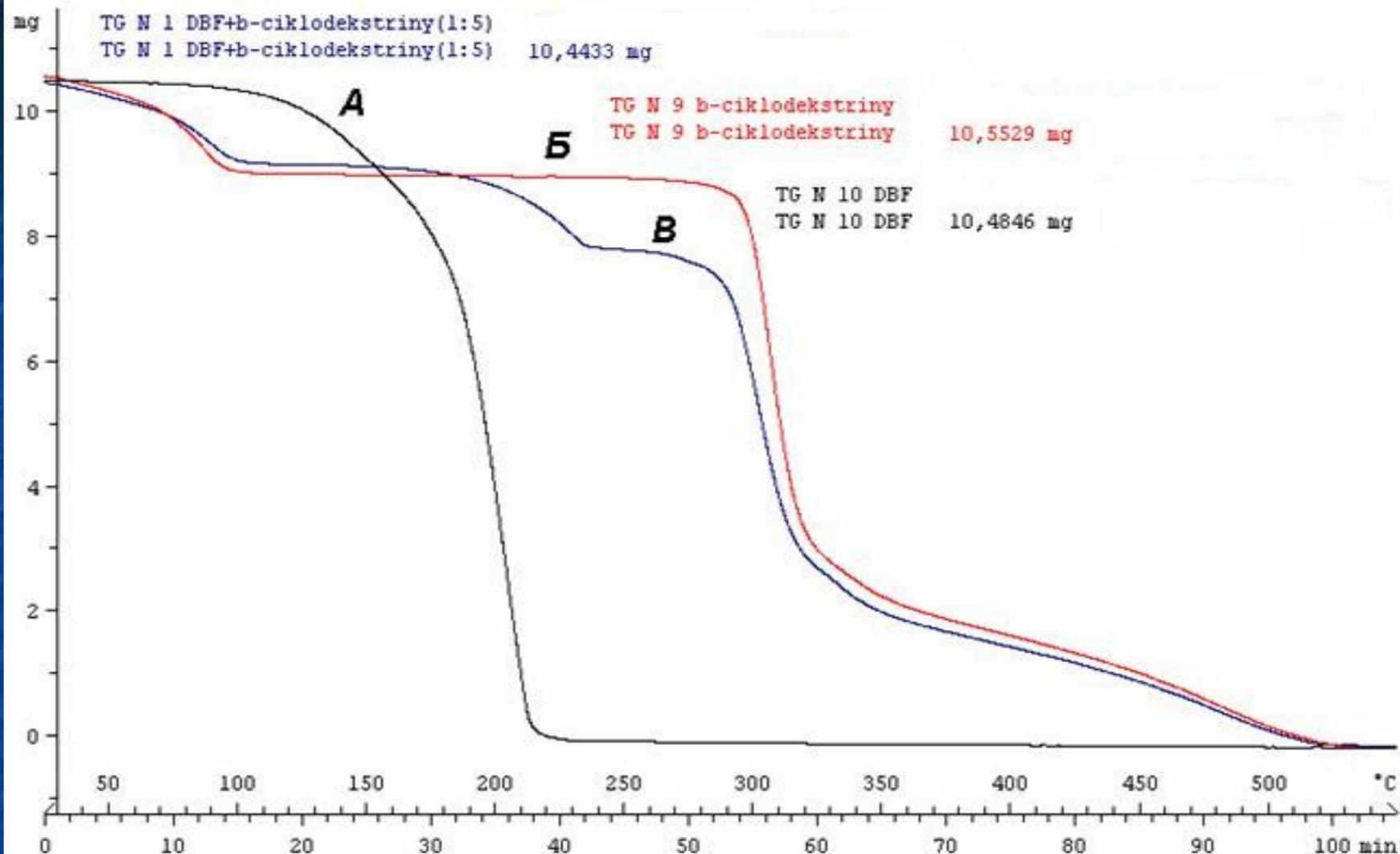
Рис. 7. Сравнительный анализ термогравиметрических кривых  $\beta$ -циклодекстрина, ДБФ и комплекса ЦД:ДБФ (5:1).
