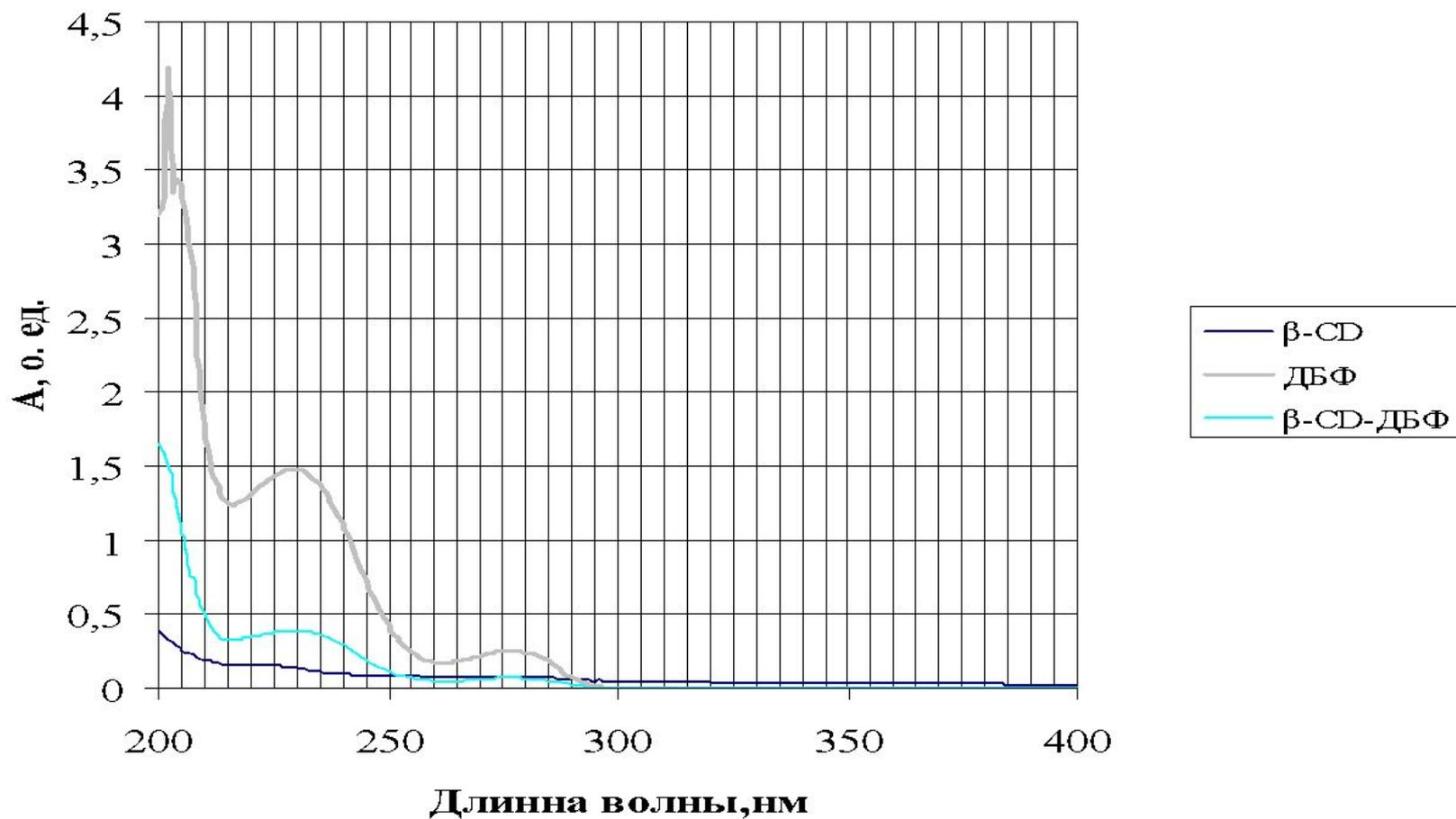
Рис. 1. Спектрофотометрический анализ растворов  $\beta$ -циклодекстрина, ДБФ и  $\beta$ -циклодекстрина:ДБФ
