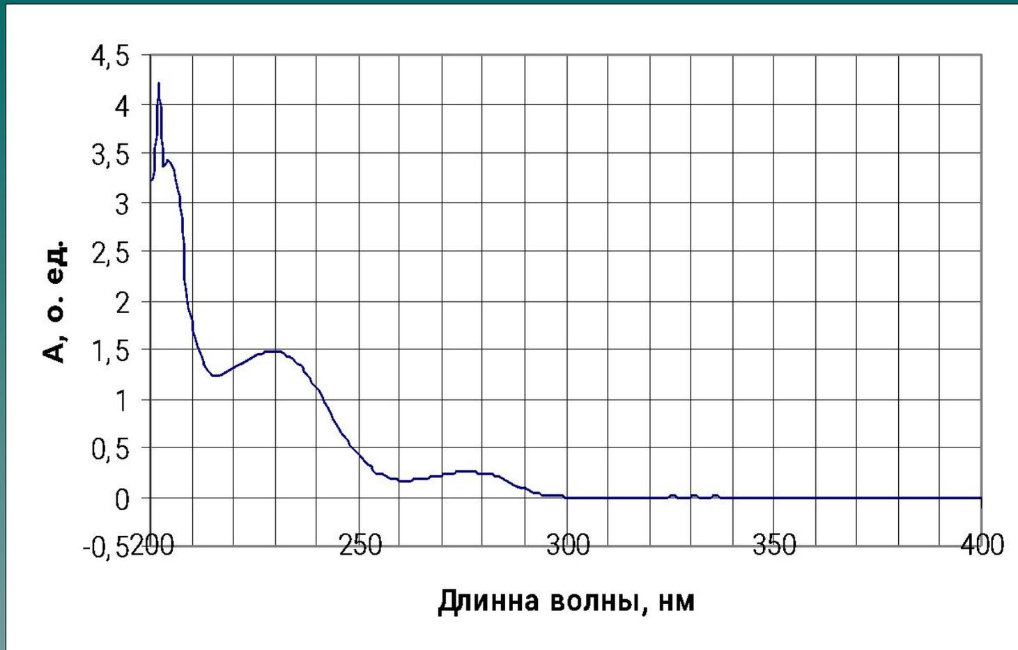
Рис. 3. Спектрофотометрический анализ раствора ДБФ
