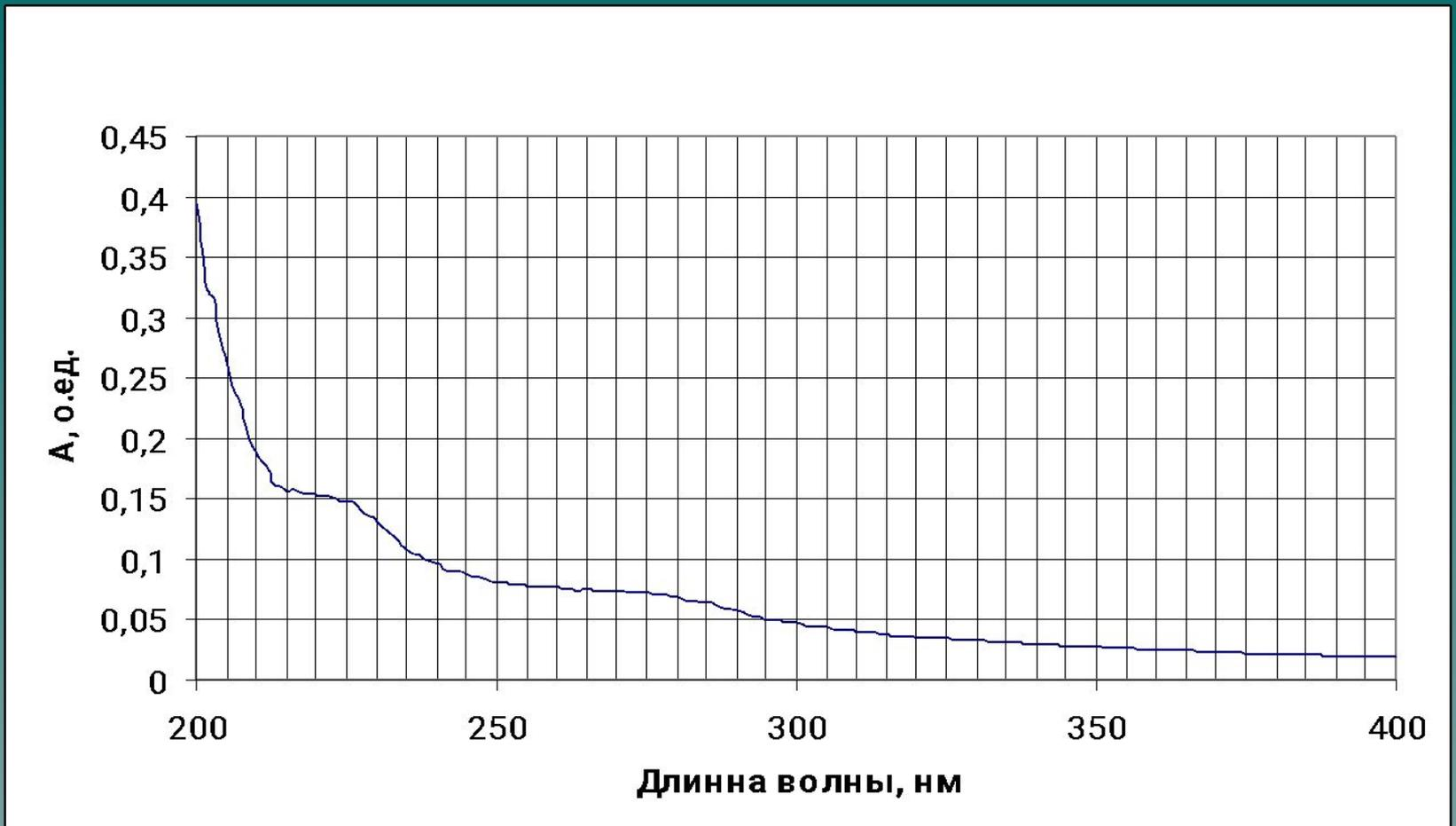
Рис. 2. Спектрофотометрический анализ раствора  $\beta$ -циклодекстрина ( $[c] = 10 \text{ мг/мл}$ ).
