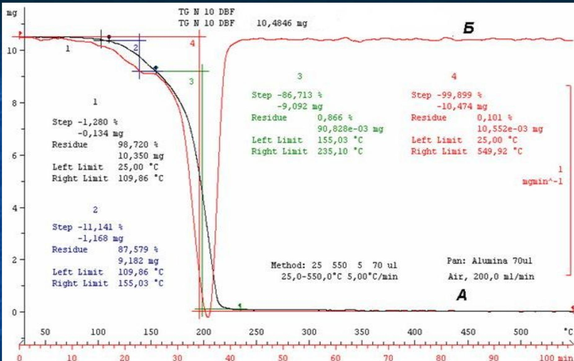
Рис. 5. Термогравиметрический анализ ДБФ.
