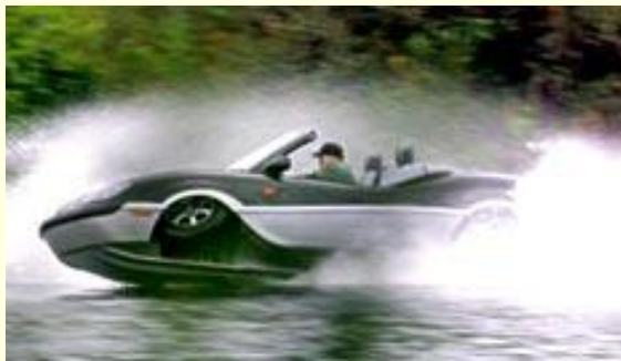
Автомобиль амфибия мчится со скоростью 56 км час по воде и 160 км час по дороге
