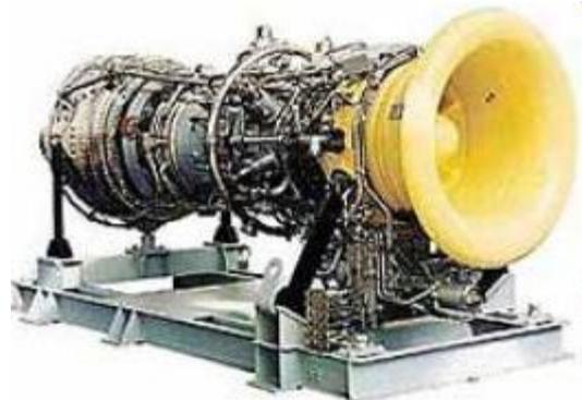
ГТУ-16П создана на базе газогенератора высокоэффективного авиадвигателя ПС-90А и газотурбинной установки ГТУ-12П. Обладает более высокими параметрами цикла (применен 14 ступенчатый компрессор) и имеет силовую турбину, адаптированную по параметрам для существующих ГПА. Применяется в составе блочно-комплектного газоперекачивающего агрегата ГПА-16 «Урал» производства ОАО «НПО «Искра» и при реконструкции существующих газоперекачивающих агрегатов ГТК-10, ГПА-Ц-16, ГПУ-16, ГПУ-10 и других.
