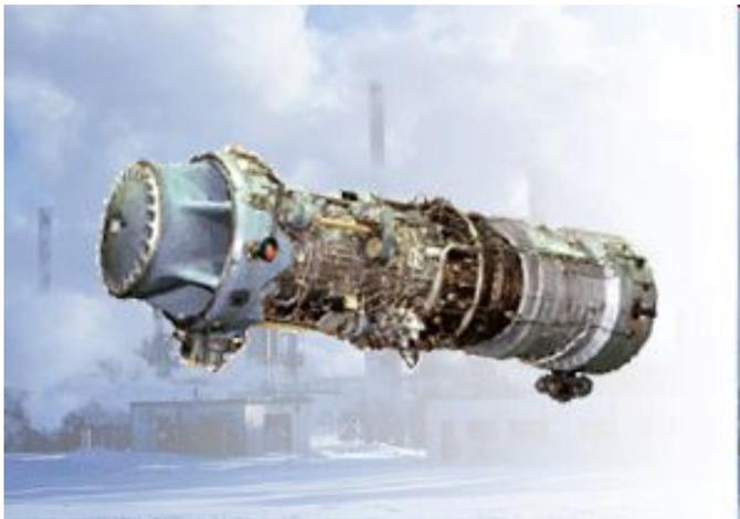
НК-12СТ первый газотурбинный двигатель авиационного типа созданный в 1974 г. для газовой промышленности на базе авиационного турбовинтового, двигателя НК-12МВ, который устанавливается на самолетах ТУ-95, ТУ-144, АН-22 и др.
