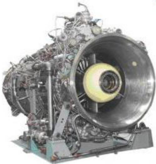
Модифицированная газотурбинная установка ГТУ-6ПГ с мультипликатором М-60 создана для привода центробежного компрессора газоперекачивающих агрегатов.
