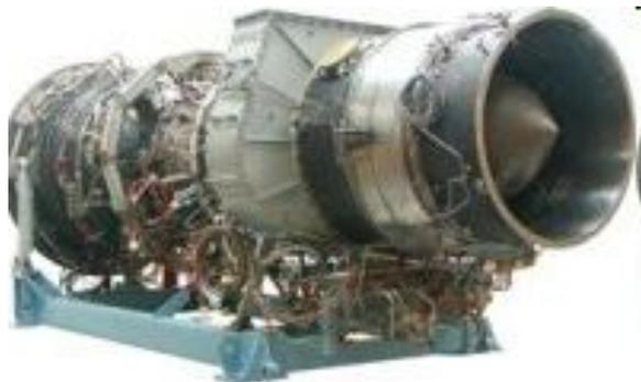
Самая мощная среди пермских установок 25-мегаватная ГТУ-25П предназначена для привода газовых нагнетателей в составе газоперекачивающих агрегатов нового поколения и модернизации устаревшего оборудования, а также для закачки газа в подземные хранилища.
