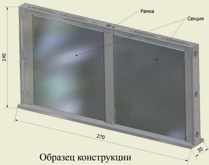
Внутренняя структура секции из ГТПС
