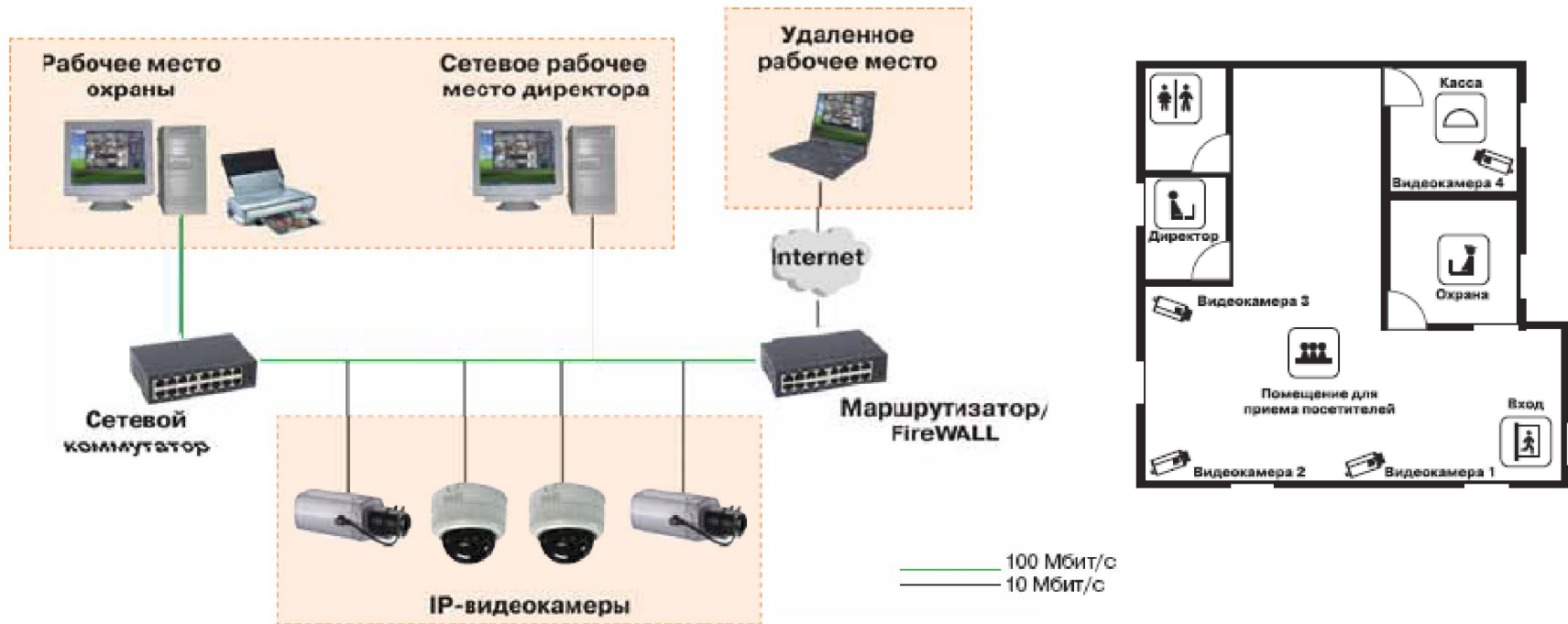
Типовая структурная схема системы для малых объектов (до 4-х IP-камер)
