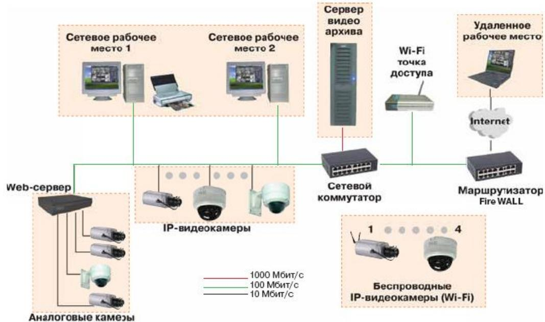
Типовая структурная схема системы для средних объектов (от 5 до 16-х IP-камер)
