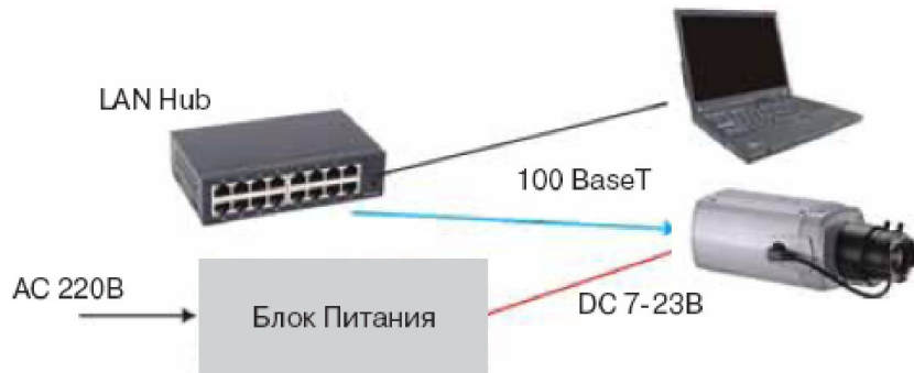
1. Подключение с помощью стандартного БПС
