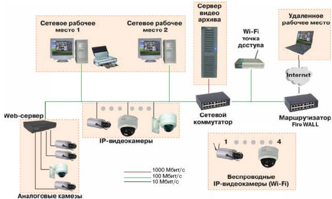
Типовая структурная схема системы для средних объектов (от 5 до 16-х IP-камер)
