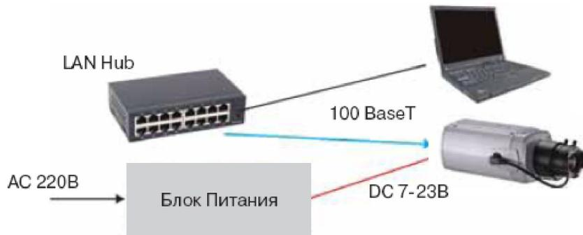
1. Подключение с помощью стандартного БПС
