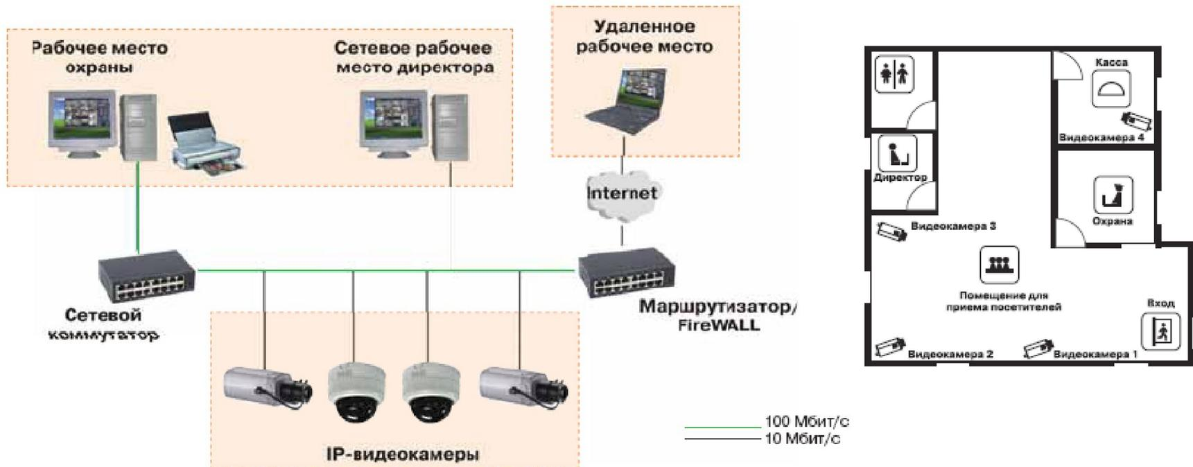
Типовая структурная схема системы для малых объектов (до 4-х IP-камер)
