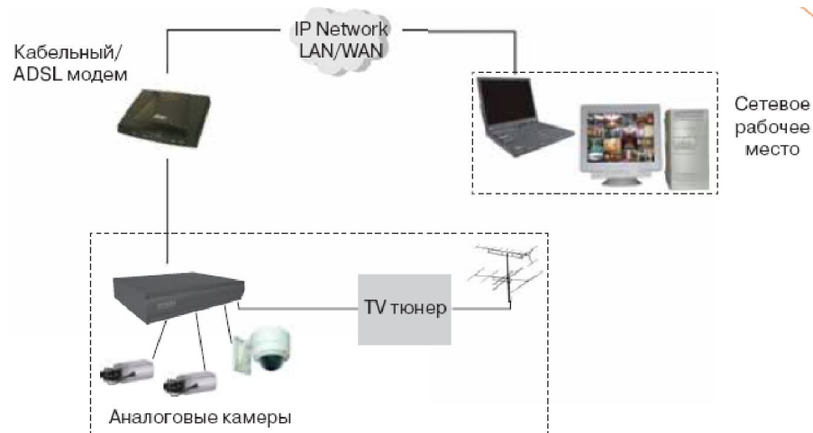
3. Подключение в сеть через модем
