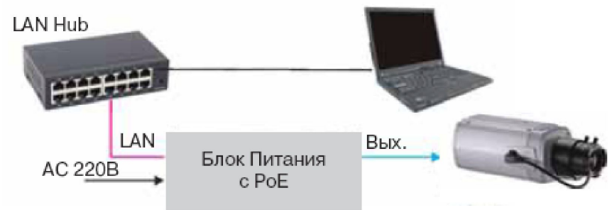
2. Подключение с помощью БП с PoE
