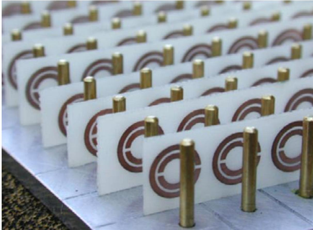
Фотография метаматериала с отрицательным показателем преломления
