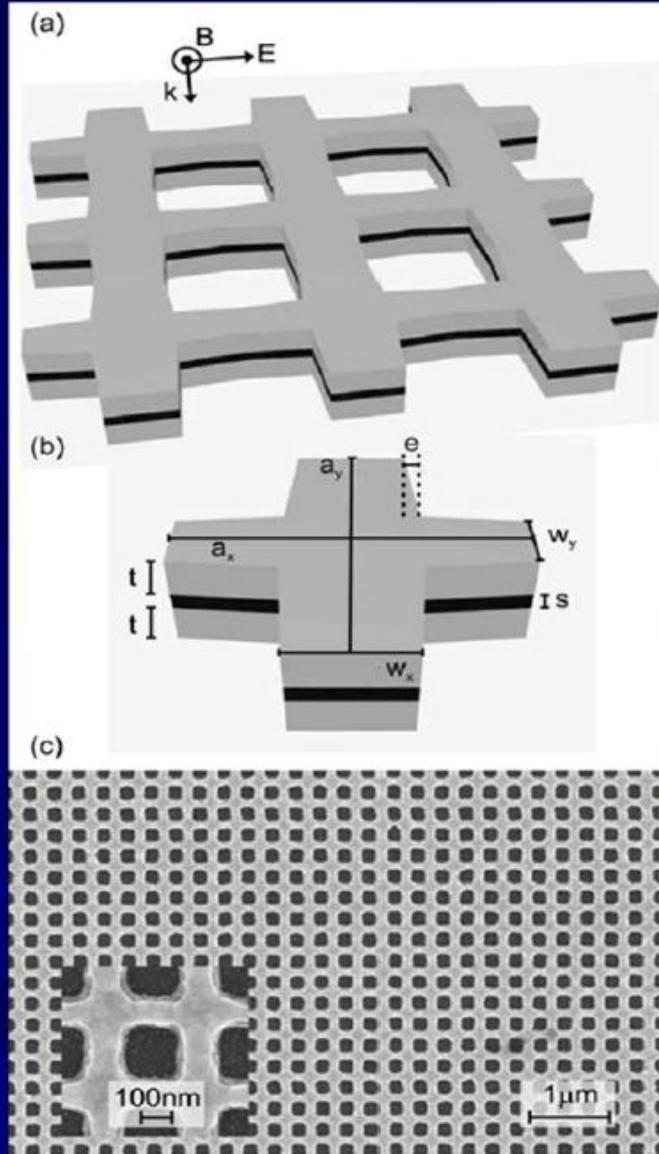
Периодическая структура из трех слоев МДМ (Ag–MgF<sub>2</sub>–Ag,  $n=1.38$ ) толщиной на стекле с размерами:  $a=300\text{nm}$ ,  $W_x=102\text{nm}$ ,  $W_y=68\text{nm}$ ,  $e=8\text{nm}$ ,  $t=40\text{nm}$
