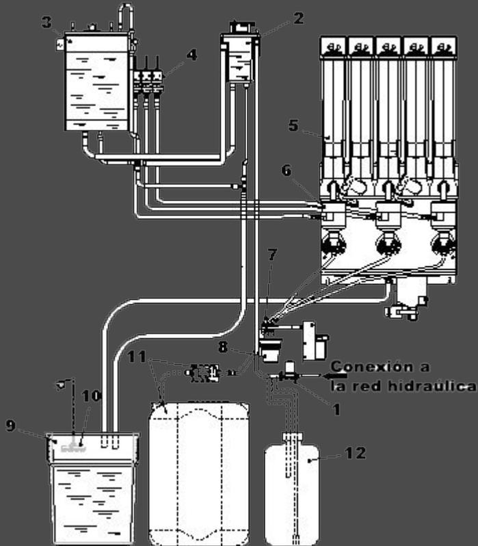
1. Водоприемный электромагнитный клапан
