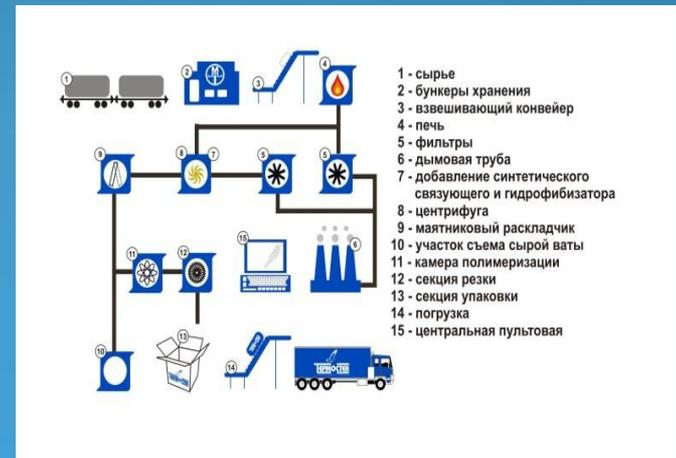
Упаковочная машина - заключительный узел производственной линии. Здесь продукция заворачивается в термоусадочную пленку. В термоусадочной камере процесс упаковки завершается.
