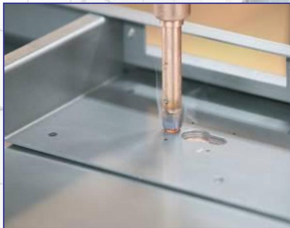
Технологические отверстия под крепление замков, фурнитуры выполнены с помощью координатной вырубки, имеют строго определенные размеры и положение на полотне. Внутренний лист металла также вырубается, гнется, образуя по трем сторонам направляющие для установки панели. Внутренний лист соединен с конструкцией дверного полотна по периметру с помощью точечной сварки.
