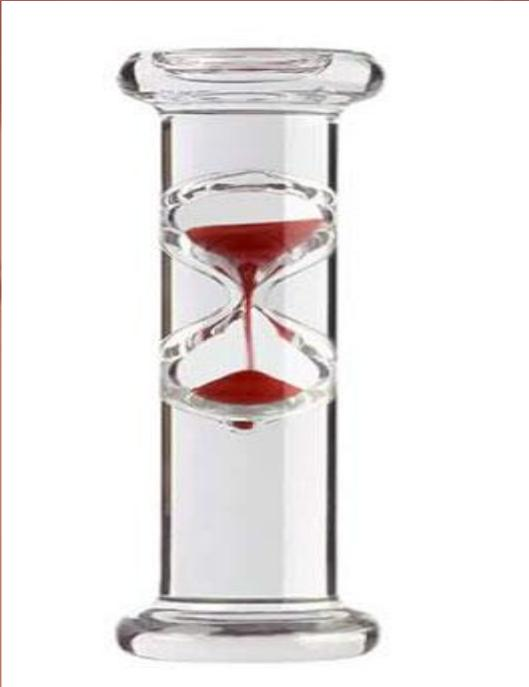
Для измерения времени можно использовать не только равномерное сгорание свечи или масляной лампы, но также истечение из сосуда, воды или песка. Песочные часы используют и сей день. Они состоят из двух грушевидных емкостей, соединенных, между собой узкими концами. Песок перетекает из верхней части сосуда в нижнюю за определенное время.
