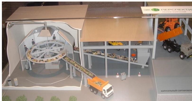
Основное отличие мусоросортировочного комплекса от традиционной линейной схемы – компактная карусельная компоновка.
